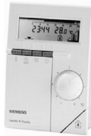
Unidad de ambiente QAW70 con sonda ambiente, reloj, ajuste de consigna y reajuste de la temperatura ambiente (botón de ajuste)
